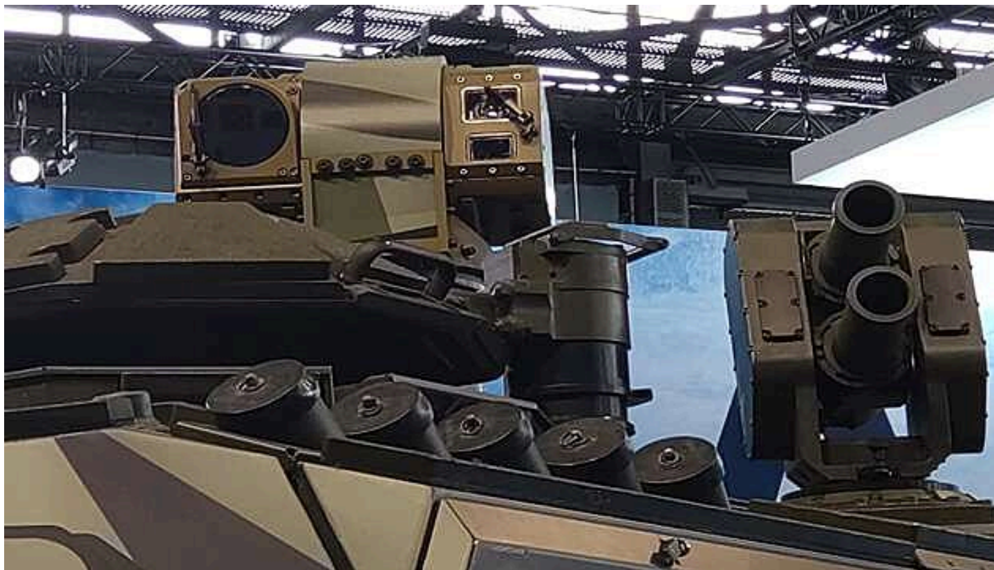
Velitelský zaměřovač CMS-1 od EVPU Defence na vozidle CV90 na EUROSATORY 2024
